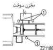
محل فیلتر سوخت (بر اساس مدل فرق می‌کند)
